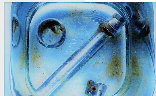
Foto 1: Komponenten aus 316Ti (1.4571) mit traditionellem Härting Prozess behandelt
