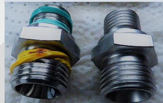
Foto 2: 316Ti (1.4571) Fittings ohne und mit Expanite
