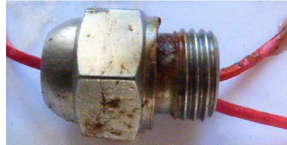
Foto 4: 303 (1.4305) Düse ohne Oberflächenhärtung
