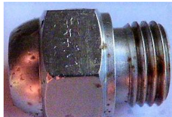
Foto 5: SuperExpanite behandelte Düse aus 303 (1.4305) Komponente mit SuperExpanite Härtung with SuperExpanite
