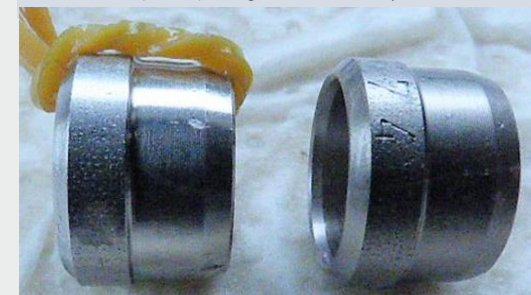
Foto 3: Schneidringe aus Duplex (1.4462) ohne und mit SuperExpanite Behandlung
